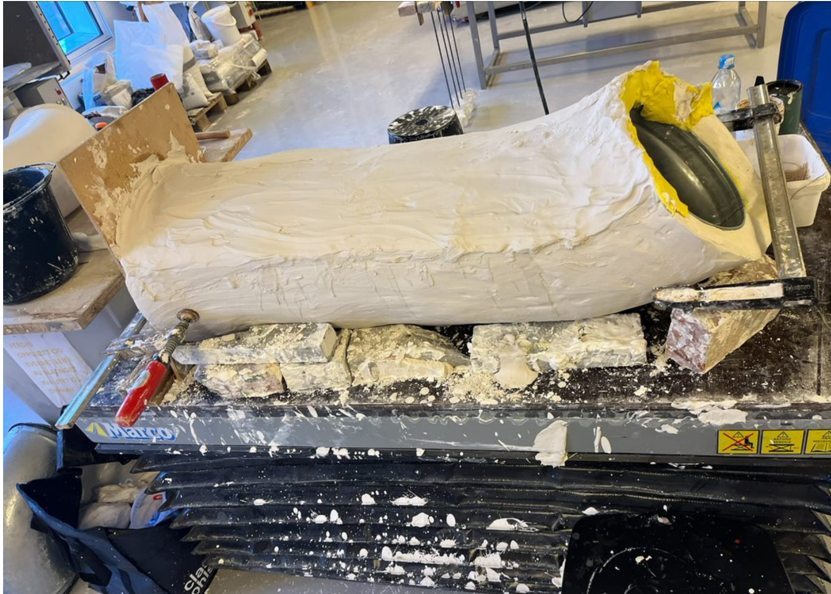
Gipsform herder rundt ventilasjonsrør
