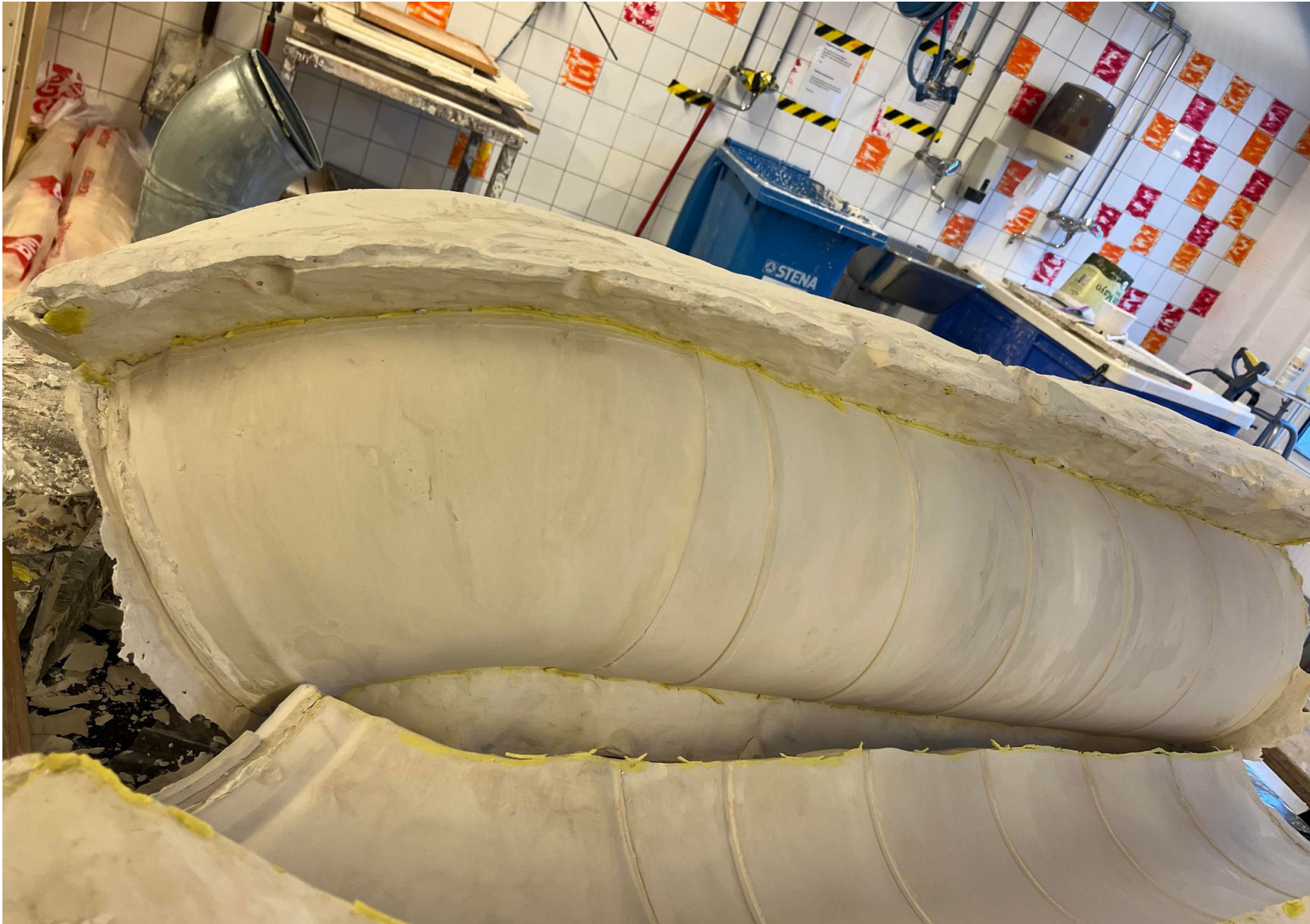
2 Åpning av støpeform
