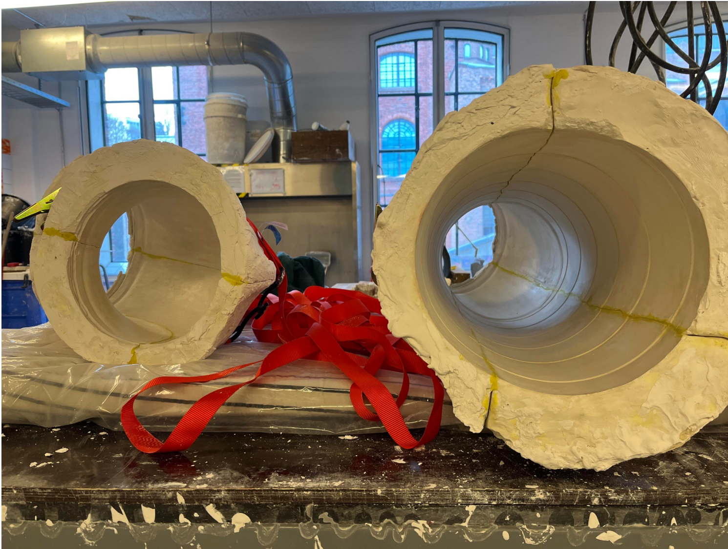
To gipsformer klar for støp
