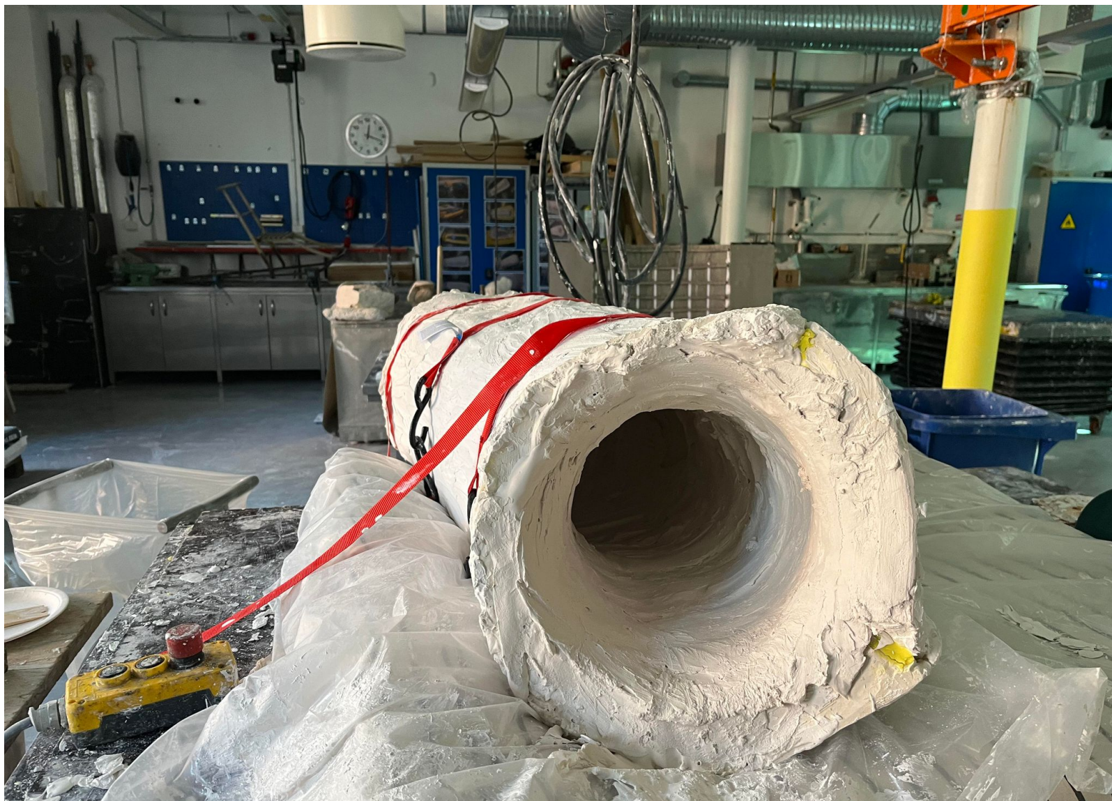
Gipsform med støp inni
