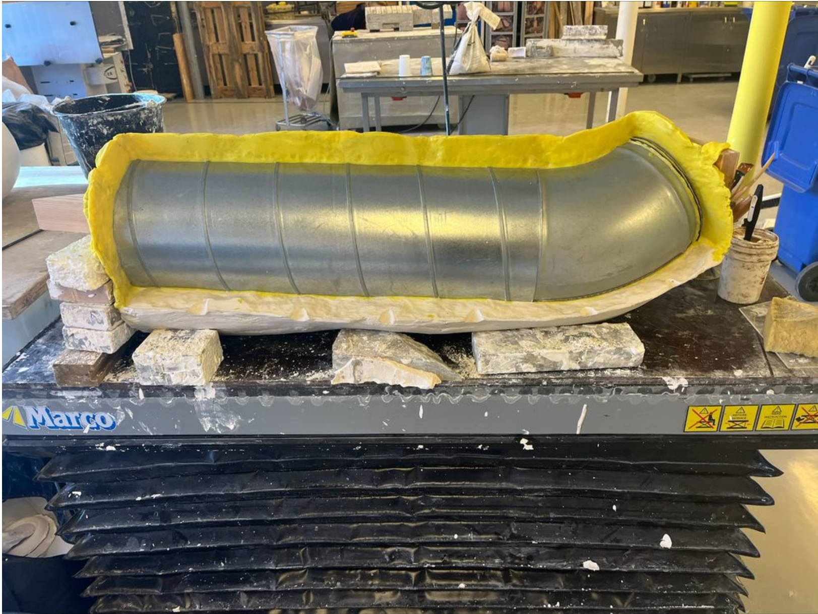
Modellering av gipsform rundt ventilasjonsrør
