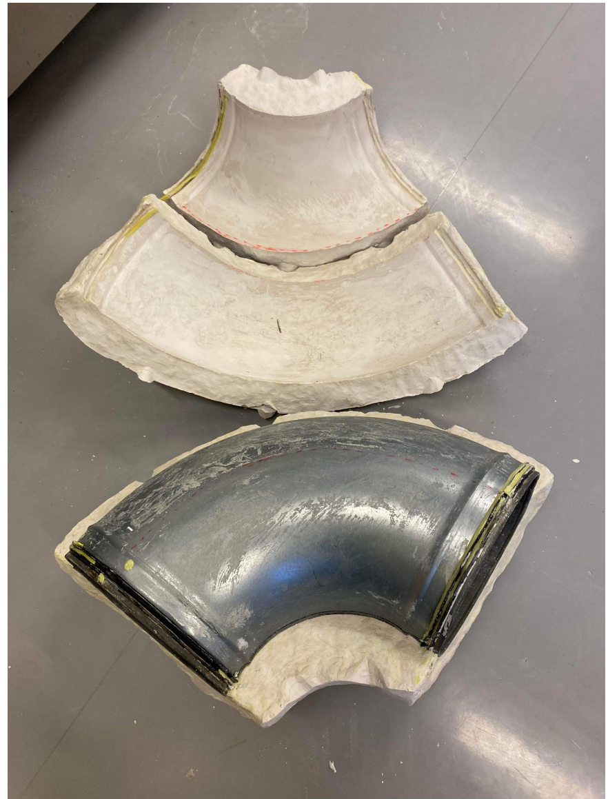
1 ventilasjonsrør, muffe, i gipsform
