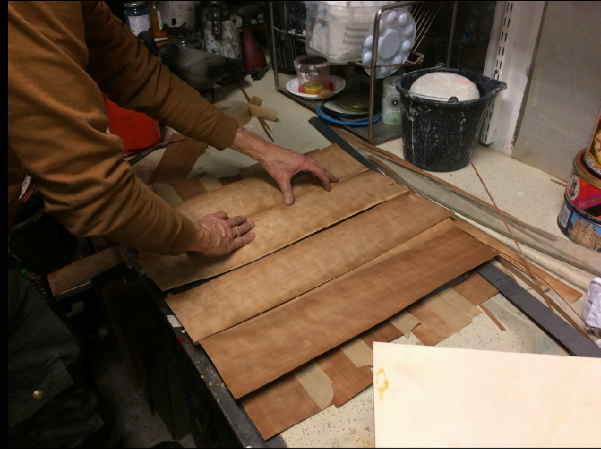
Trommemembran lages av diagonalt kryssende lag tynn finér på jakt etter en dypere klang i materialet.
